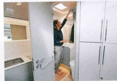
Im Heck ist der Sanitärraum mit abtrennbarer Duschkabine untergebracht.
